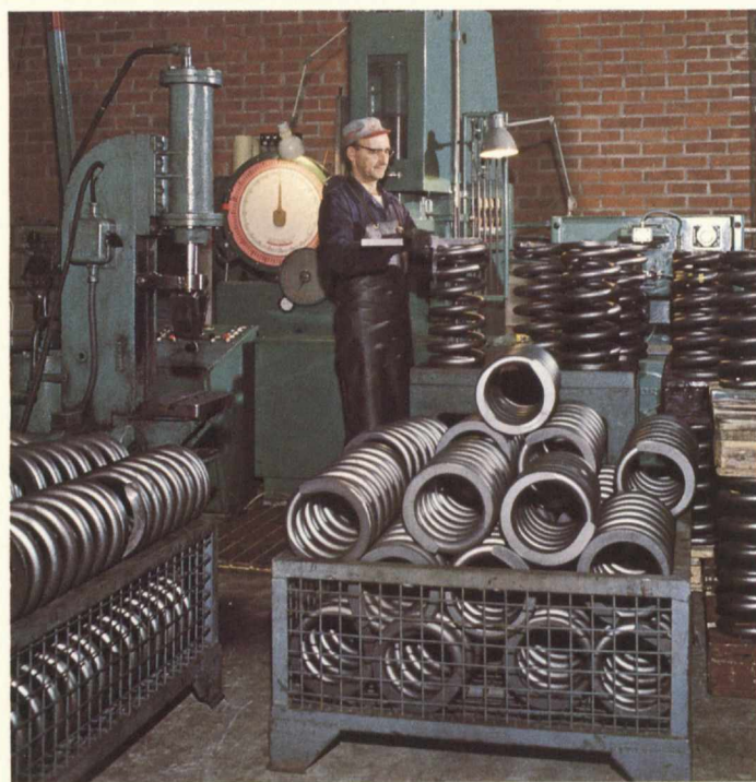
Kierrejousien valmistusta Jousitehtaalla
