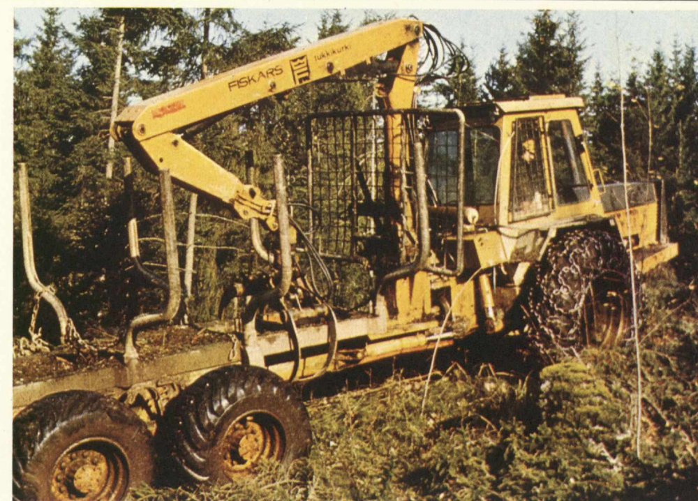
Hydraulinosturi F 6000, traktorin pyörissä Loimaan tehtaiden kittaketjut
