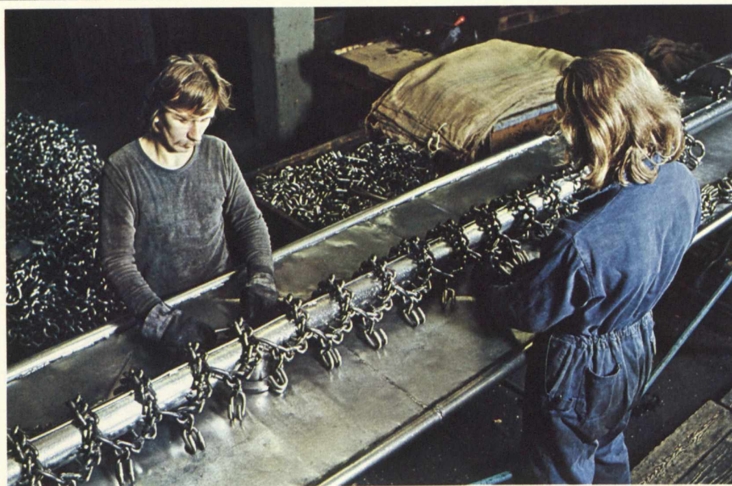
Reima Niemi ja Kari Lehtola kokoamassa traktoriketjuja lopulliseen kuntoon Loimaan tehtailla.
