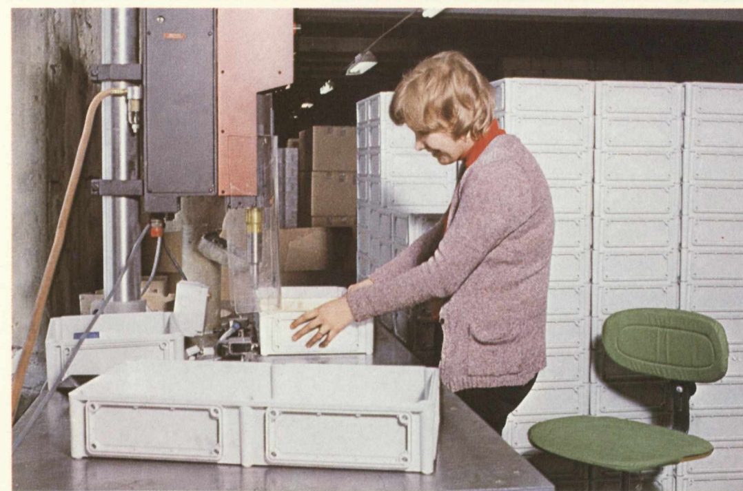
Ultraäänihitsausta Muovi- tehtaalla. Jakokeskuskoteloita hitsaamassa Maija-Leena Forsström.
