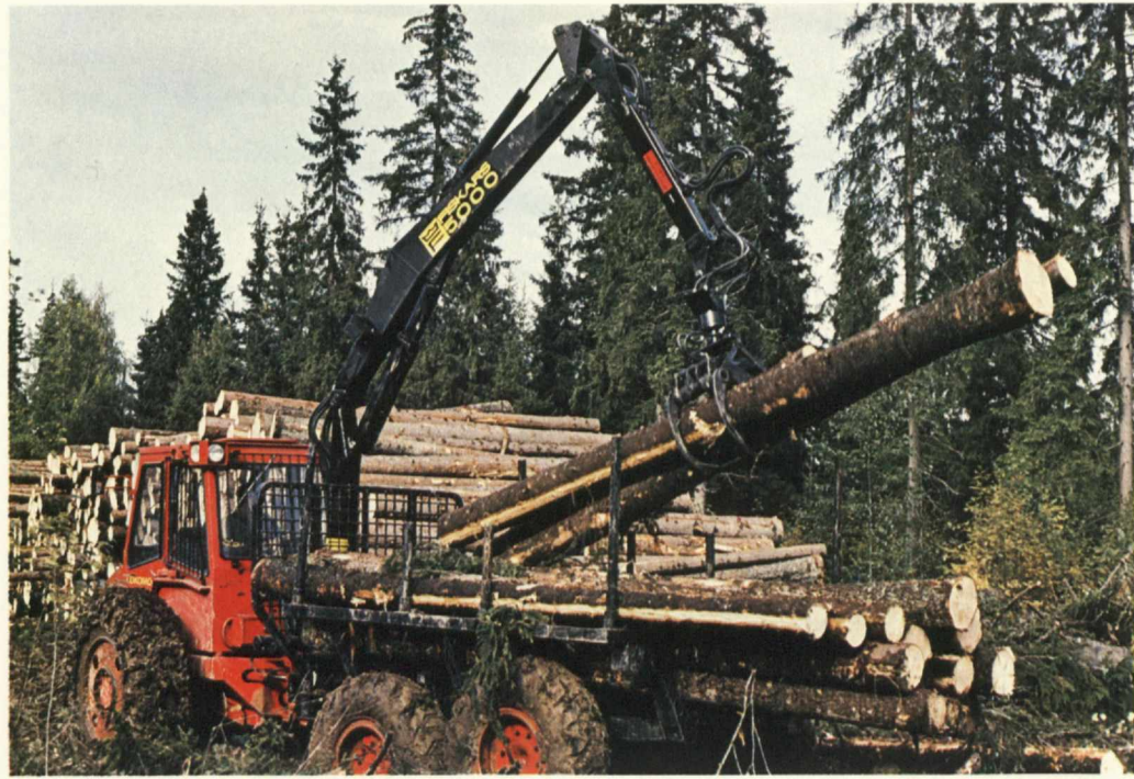
Metsätraktoriin asennettu hydraulinen puutavara-nosturi F 5000 L on tuonut metsästä tukkeja, jotka nyt puretaan välivarastoon.
