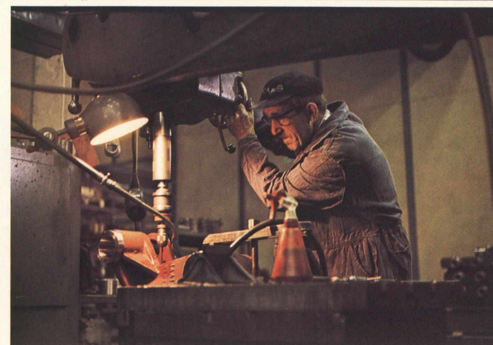
Sulo Haanpää poraamassa F 9000 Z puutavaranosturin pylvään alaosa. Kuvaaja: Matti A. Sjöberg, Salon konepaja. Yhtiön valokuvauskilpailussa palkittu kuva.
