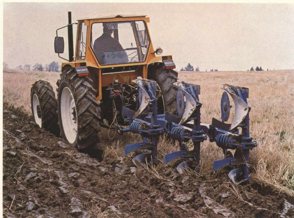
Agropal-paluuaura on Fiskarsin konepajan uutuus. Paluuauraa ei ole aikaisemmin valmistettu Suomessa. Agropal helpottaa kyntöä, koska paluuvako voidaan kytää kääntämällä aura oman pituusakselinsa ympäri.
