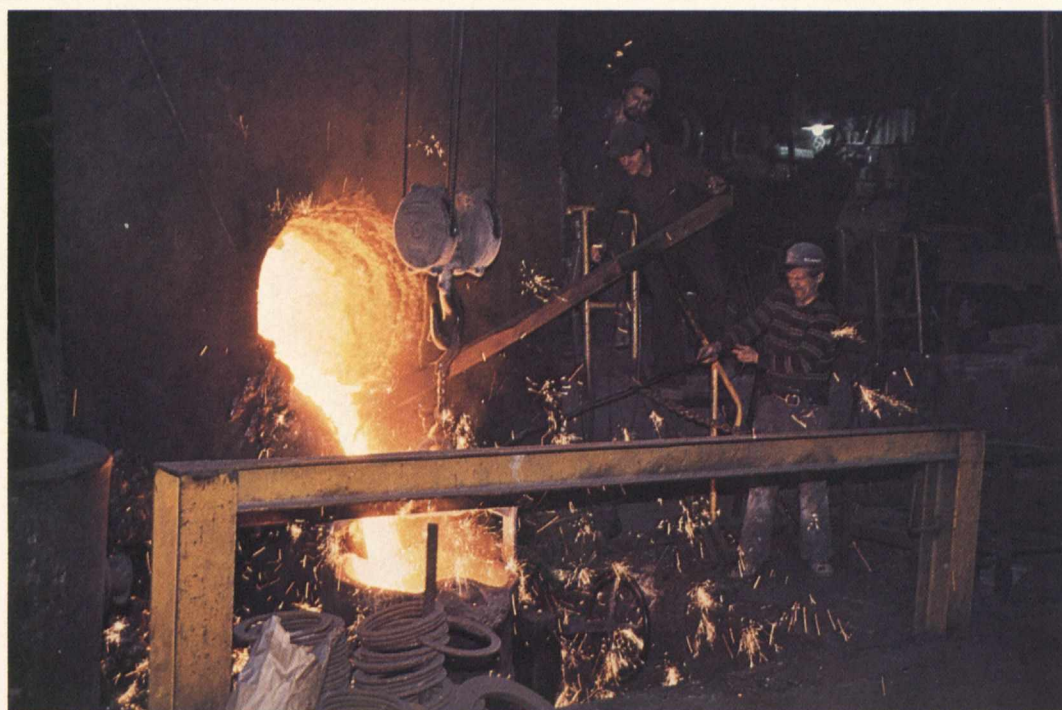
Terästä valetaan Salo- valimossa. Aimo Heinonen, Martti Junttila ja Matti Nieminen laskevat parhaillaan sulaa terästä uunista valu- senkkään. Kuvaaja: Arto Koivukangas, Salon konepaja. Kuva on palkittu yhtiön valokuvauskilpailussa.
