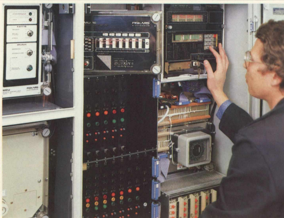
Elektroniikkatehtaan laadunvalvonnessa lopullinen tuote, tässä tapauksessa liikenteen ohjaukseen tarkoitettu risteyskoje, käy läpi tarkan lopputarkastuksen ennen toimitusta asiakkaalle.
