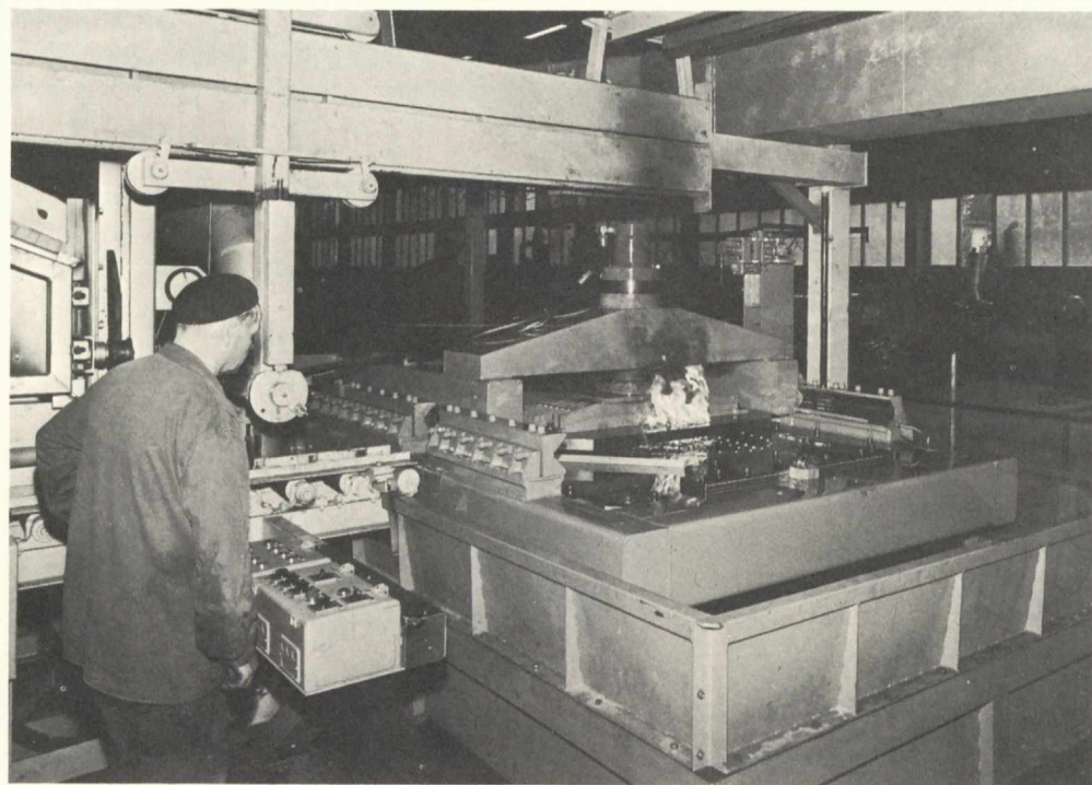
Automatisk tillverkning av plogdetaljer i Fjäderfabriken
