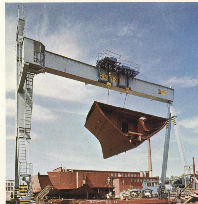
Bockkran tillverkad av Salo Mekaniska verkstad
