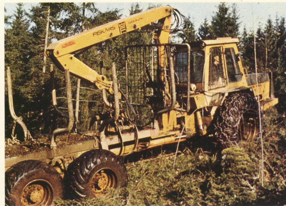
Hydrauliska timmerkranen F 6000; traktorn är försedd med slirkätting från Loimaa fabriker
