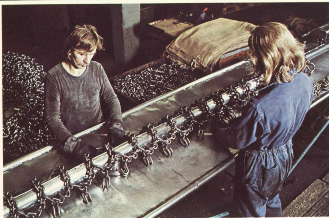
Reima Niemi och Kari Lehtola slutför monteringen av traktor- kedjor vid Loimaa fabriker.
