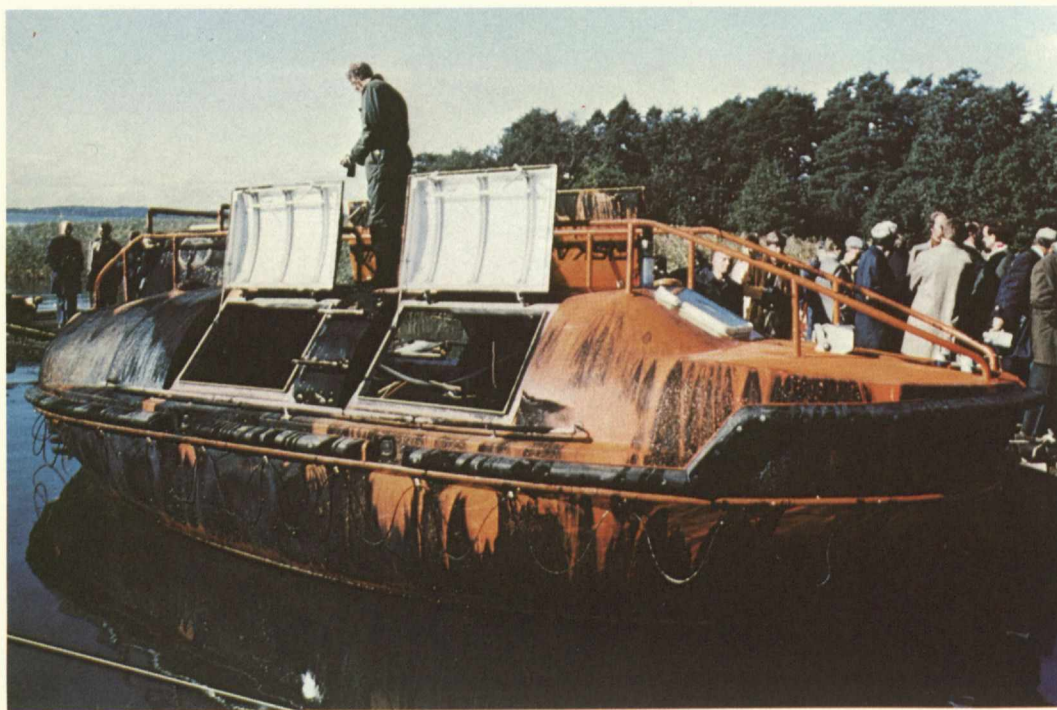
Livbåten Fiskars Survival 27 för tankfartyg efter genomgången brandsäkerhetstest.
