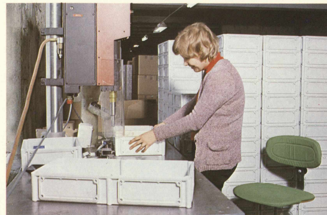
Ultraljudsvetsning på Plastfabriken. Maija-Leena Forsström svetsar kapslingar för elcentraler.
