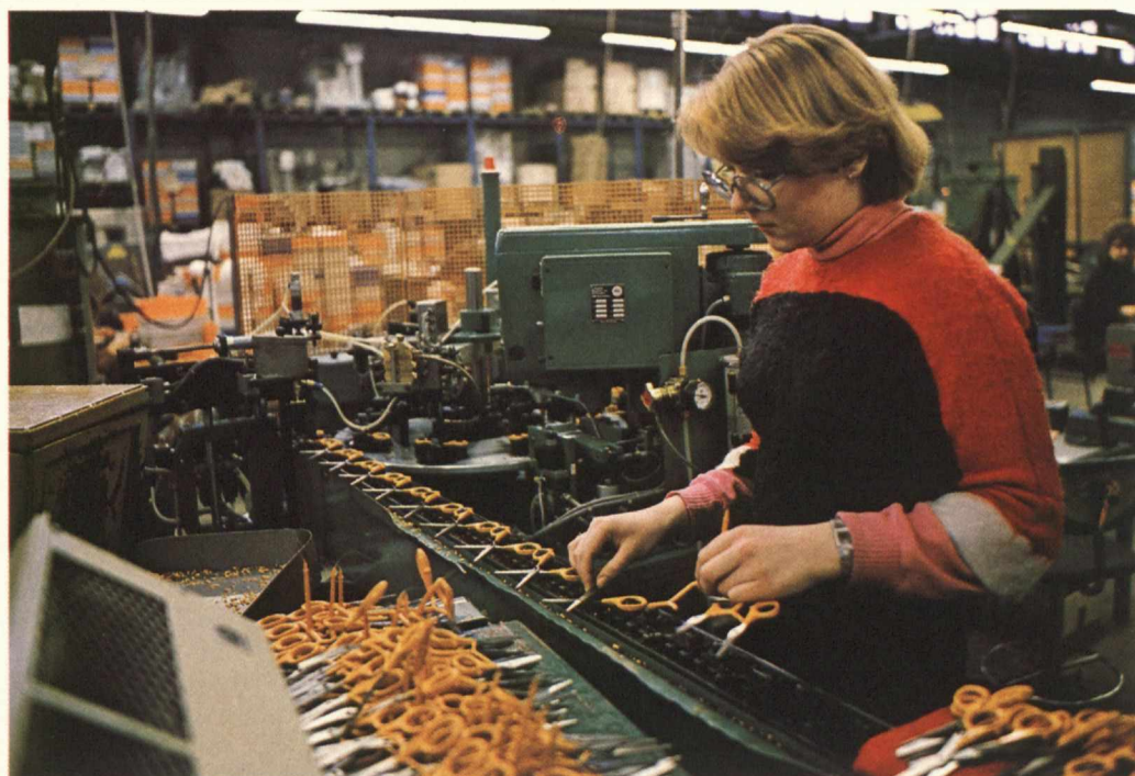
Sirpa Pulkkinen vid matningsbandet till den automatiska saxnitningsmaskinen i Saxfabriken.
