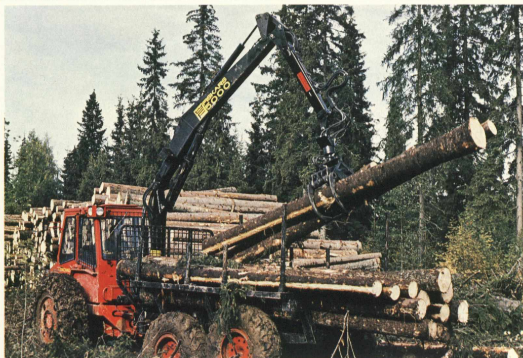
Den hydrauliska timmerkranen F 5000 L – monterad på en skogstraktor – har samlat stockar i skogen, vilka här lossas i ett mellanlager.
