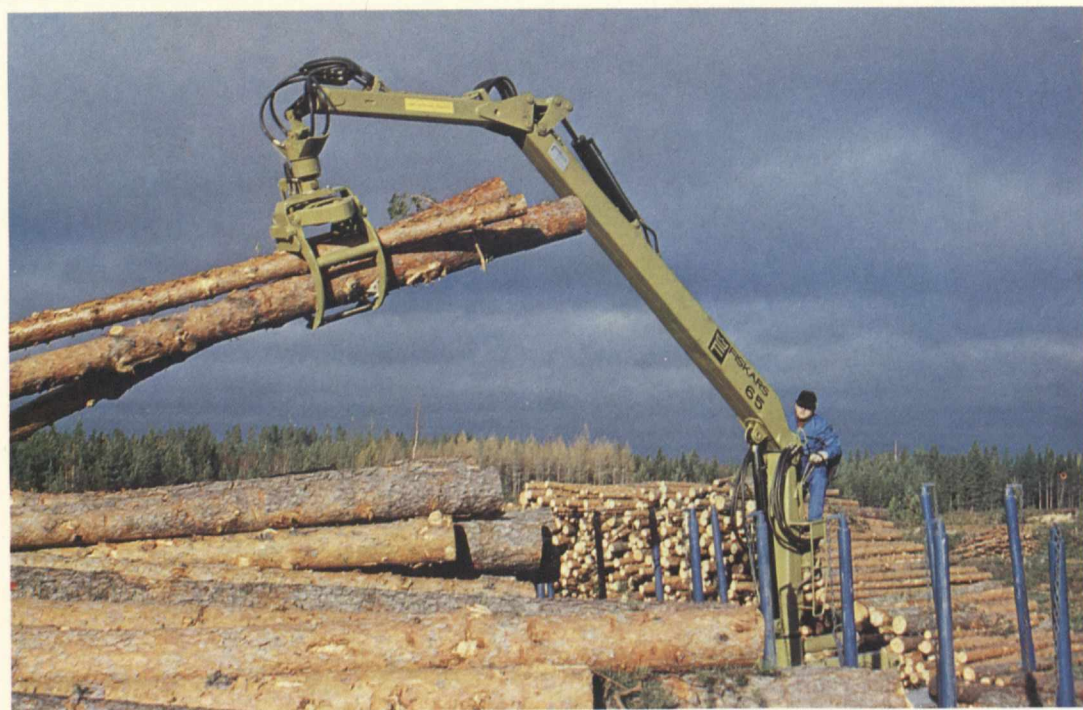
Den nya hydrauliska timmerkranen F 65 S kom i början av året ut på marknaden. Denna modell är efterfrågad bl a därför, att den är lätt i förhållande till sin lyftkraft.
