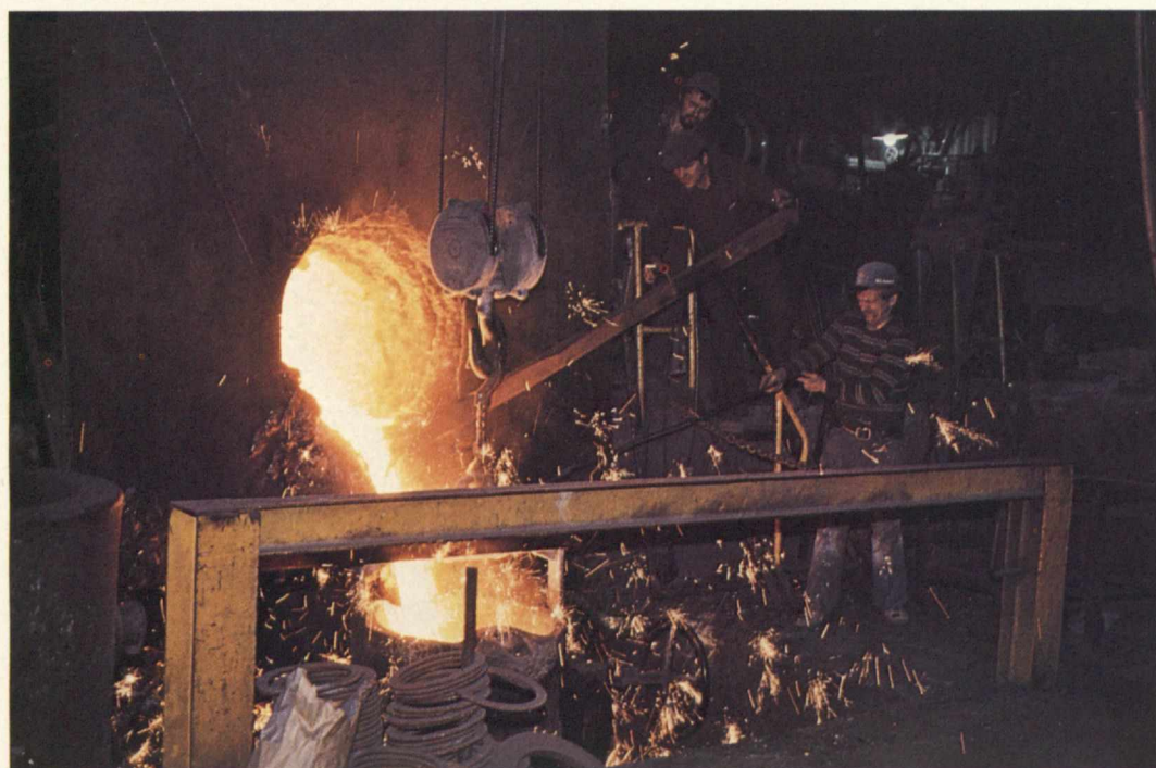
Stålgjute på Salo gjuteri. Aimo Heinonen, Martti Junttila och Matti Nieminen håller stålmältan från ugnen i gjutskänken. Fotograf: Arto Koivukangas, Salo mekaniska verkstad. Bilden prisbelönad i bolagets fototävling.
