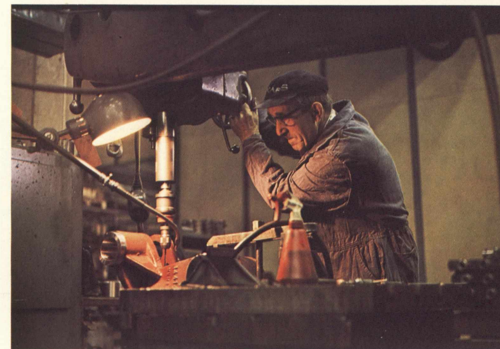
Sulo Haanpää borrar F 9000 Z kranpelarens nedre del. Fotograf: Matti A. Sjöberg, Salo mekaniska verkstad. Bilden prisbelönad i bolagets fototävling.
