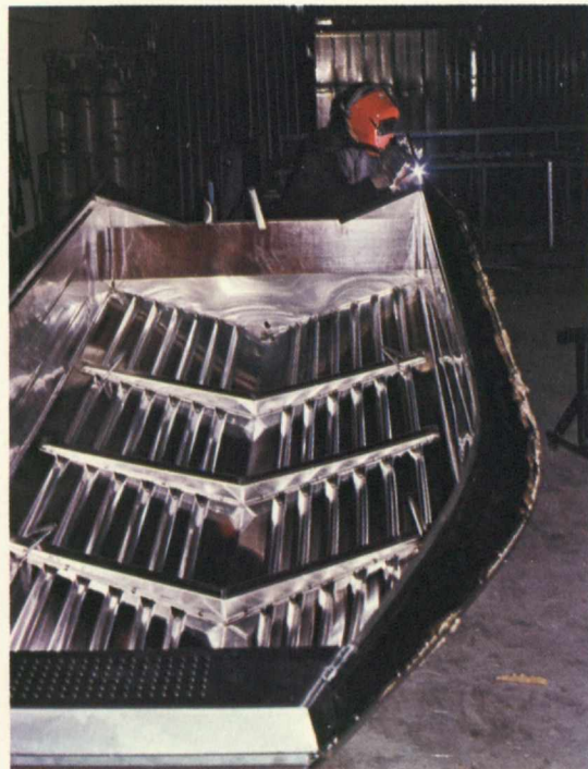
Mauno Leppälä svetsar akterspegeln på WorkBuster. Fotograf: Oiva Järvinen, Inha fabriker. Bilden prisbelönad i bolagets fototävling.
