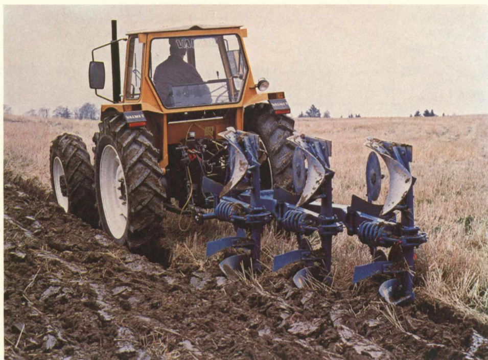
Växelplogen Agropal är en nyhet från Fiskars mekaniska verkstad. Växelplogar har inte tidigare tillverkats i Finland. Agropal underlättar plöjningen, då returfåran kan plöjas genom att vända plogen omkring sin egen längdaxel.
