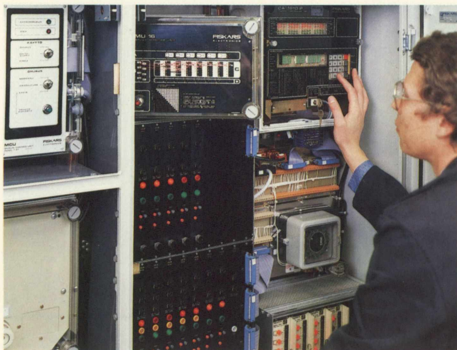
Den slutliga produkten, som i detta fall är en styrapparat för ett trafikljussystem, blir föremål för en noggrann slutkontroll, innan den levereras till kunden.
