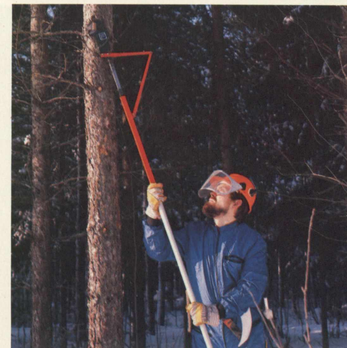
Det effektivaste sättet att förbättra virkeskvaliteten är stamkvistning. Stamkvistningsredskapen utvecklade av Fiskars skogsavdelning och Billnäs fabriker representerar ett helt nytt tänkande på forstteknikens område. På bilden visar ing. Paavo Räsänen en kvistavbitare.
