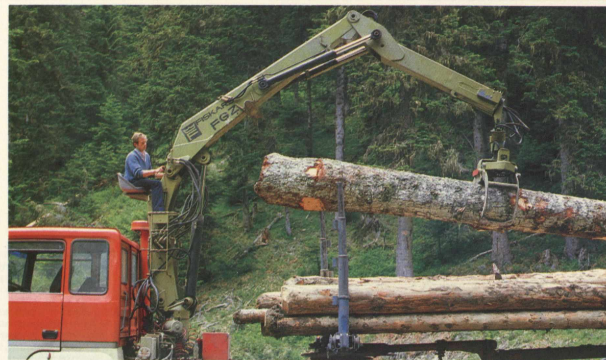
Den ihopvikbara hydrauliska timmerkranen FGZ, som är speciellt konstruerad för lastning av tunga stockar, arbetar effektivt i skogar med grovt timmer. Dessa egenskaper har gett den ett gott fotfäste i Mellaneuropa.
