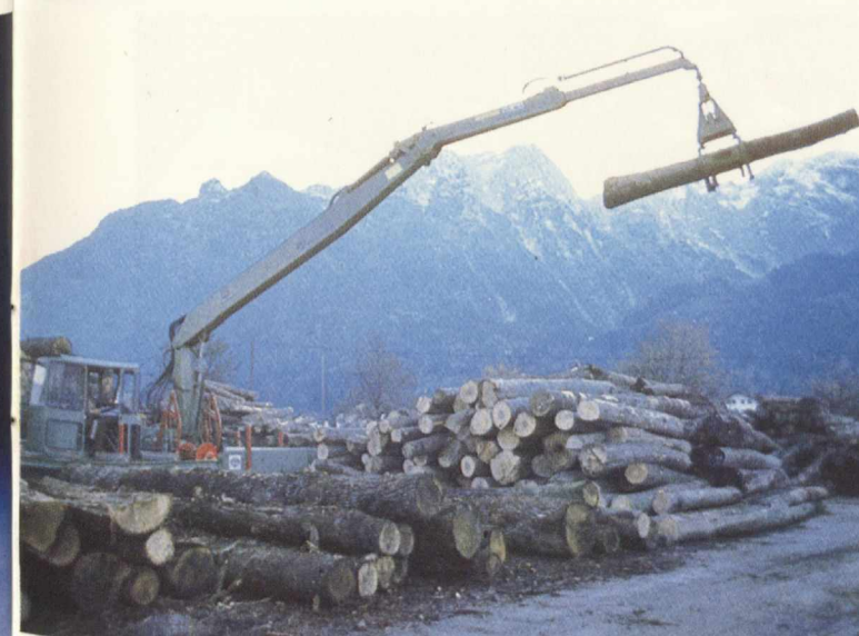
Fiskars nya specialkran avsedd för träförädlingsindustrin. Här sorterar kranen F 250 T timmer på Wimmers såg i Kuchl, Österrike.
